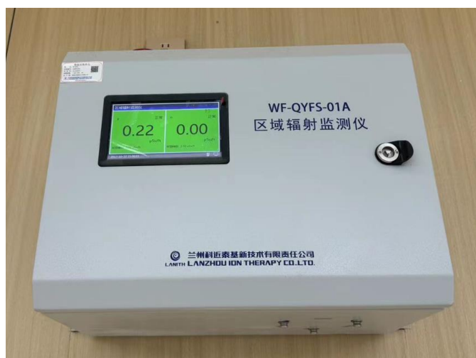
图 4.1.2-10 固定式辐射剂量监测仪现场照片（示意）
